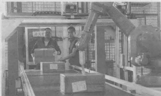
“机器人贴标 + 射频信息读写”实现自动分拣、自动关联、读取、写入数据
